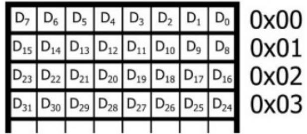
*Хранение данных с прямым порядком и с обратным порядком. "D" относится к 32-разрядному слову данных, а номера индексов указывают на отдельные биты от MSb (D<sub>31</sub>) до LSb (D<sub>0</sub>)*
