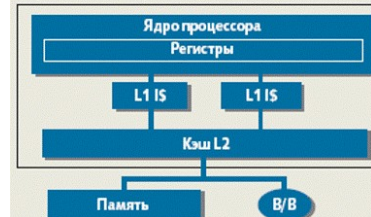
в) Многоядерная архитектура с общей кэш-памятью
