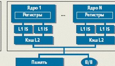
г) Многопоточковая многоядерная архитектура с общей кэш-памятью
